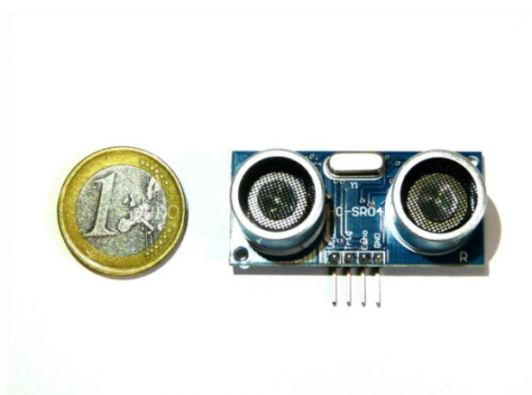
4.24. ábra: Ultrahangos detektor működése és fényképe
