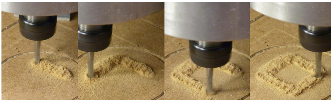
7.2.2.4. ábra: Szerszám mozgatása a munkadarabban
