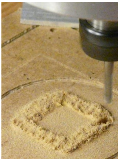
7.2.2.5. ábra: Szerszám kiemelése a marás végeztével
