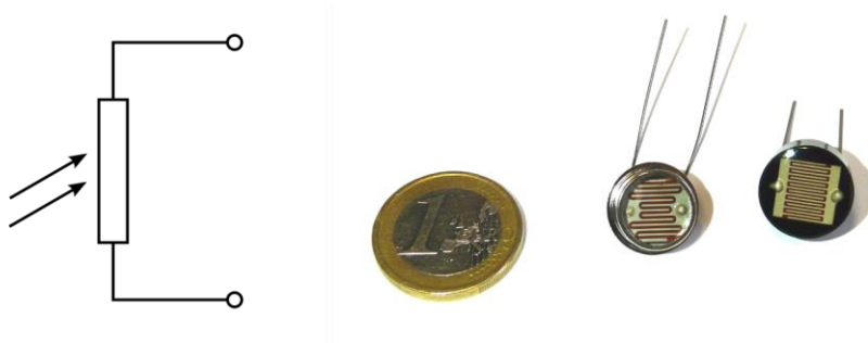
4.15. ábra: Fotoellenállás áramköri rajza és fényképe
