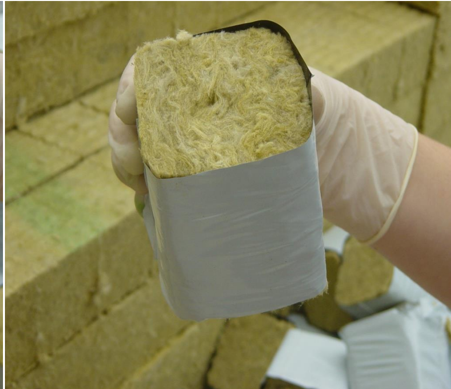
30-31-32. kép: Bazalt kőzetből készült kőzetgyapot kocka.
