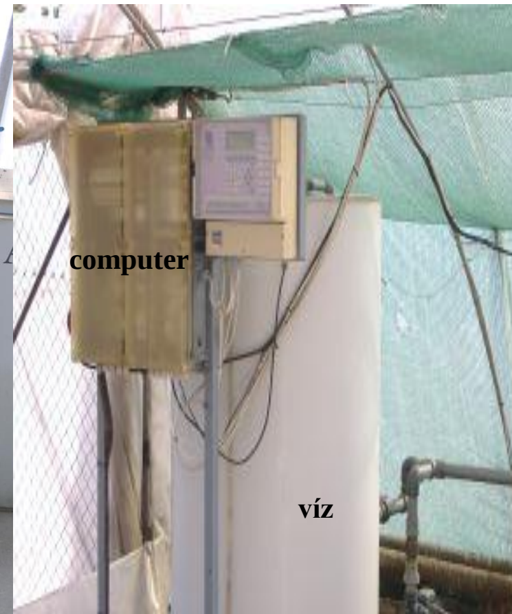
35-36. kép: 3 tartályos, automatikus tápanyagellátó rendszer.
