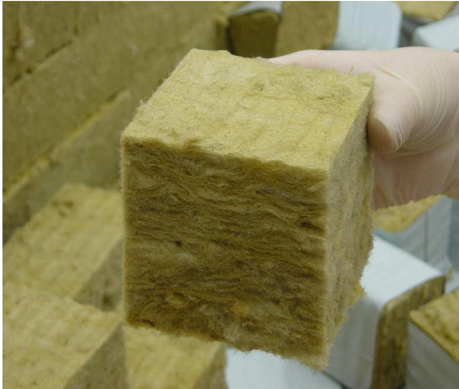
30-31-32. kép: Bazalt kőzetből készült kőzetgyapot kocka.
