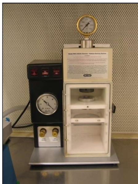
A PDS-1000/He génpuska és a biolisztikus génbevitel vázlata
