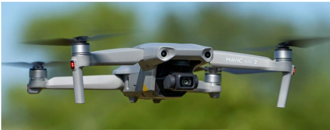
C2 osztályú dróm. amely 4 kg alatti tömegű és rendelkezik olyan rendszerrel, amely a magasságot 120 méterre korlátozza.
