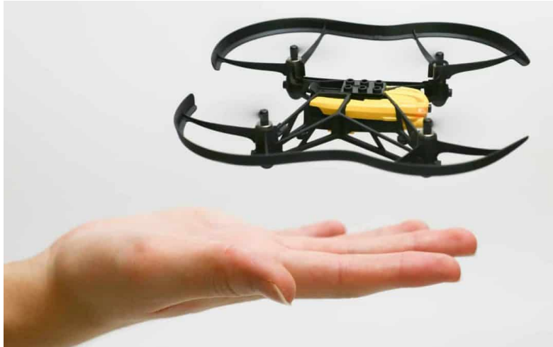
Tipikus C0 osztályú drón, 250g tömeg alatti, adatrögzítő eszköz nélkül.
