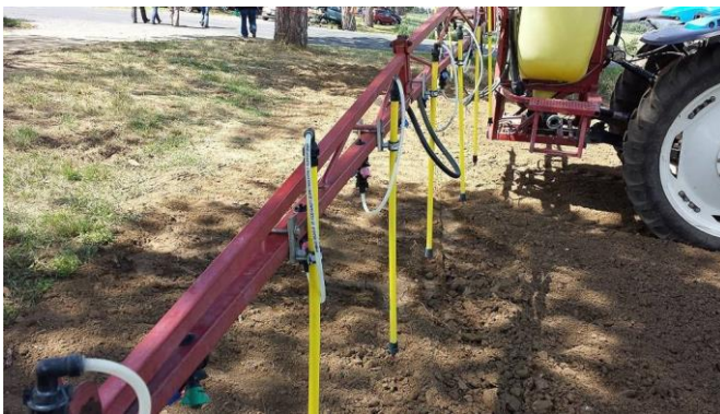
7. kép : Belógatószárakkal megoldható a késői gyomirtás magas növényeknél
