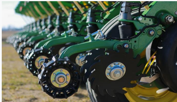
7. kép Furrow Force barázdázáró rendszer[2]
