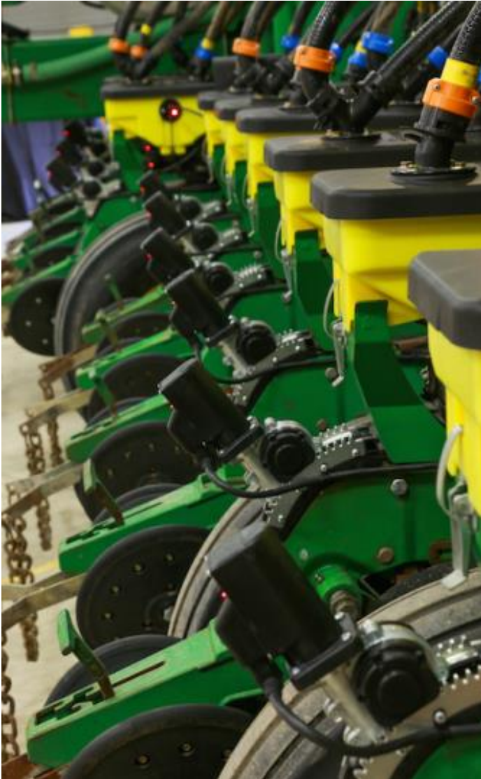
6. kép A kezelő által történő maximum és minimum mélységhatárolás lehetővé teszi a legsekélyebb vetési mélység elérését, ahol a talaj nedvességállapota megkívánt mértékű
