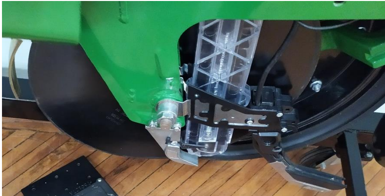
15. kép Kefés maglefordó + maglenyomó(saját kép)
