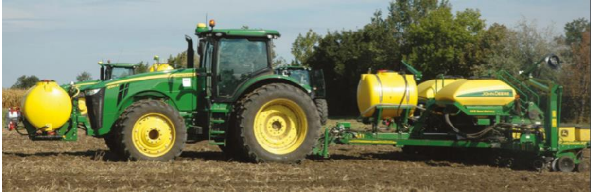
10. kép Folyékony starterműtrágya kijuttatás vetéssel egy menetben
