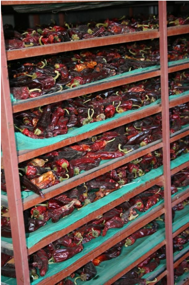
14. kép. A tálcás szárító levegőjét termoszoláris elven melegítik (San Carlos, Salta)
