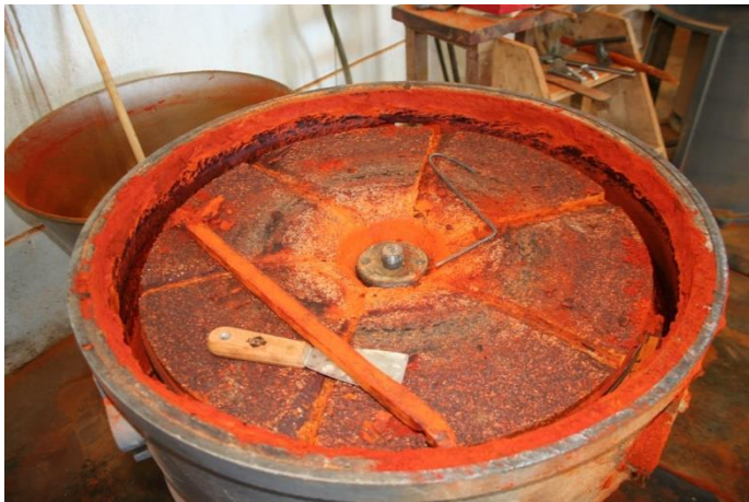
7. kép. Fűszerpaprika őrléshez használt köves malom (Santa María, Catamarca)
