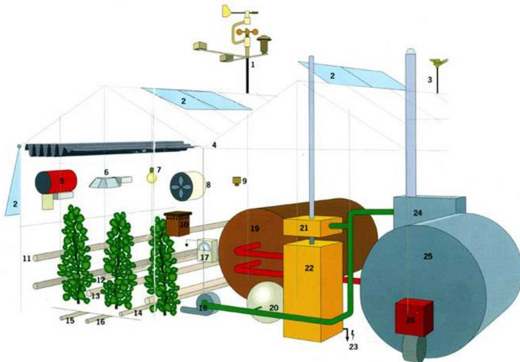
1. ábra A termesztési körülményeket optimalizáló vezérlő rendszer vázlatja
