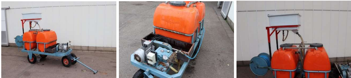
12. ábra Empas permetező kocsi 2 x 200 liter tömlőtekerccsel [ https://www.duijndam-machines.com/hu/gepek ]
