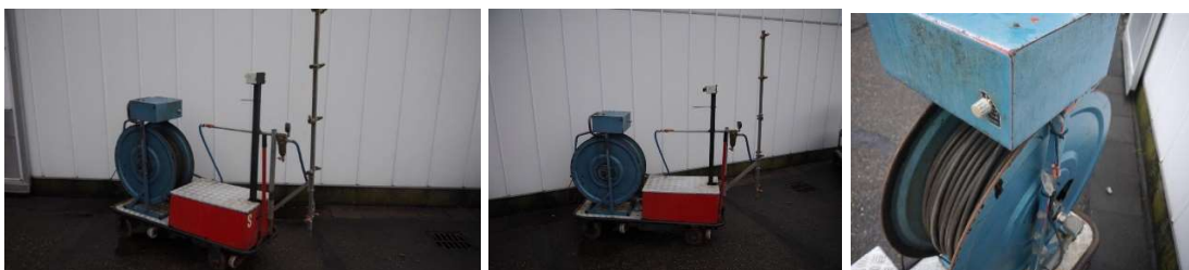
14. ábra Berg elektro permetező kocsi permetező szórókerettel 42,5 cm [ https://www.duijndam-machines.com/hu/gepek ]
