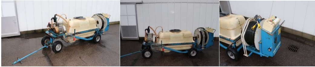
11. ábra Weterings 600 ltr. permetező kocsi elektromos házzal [ https://www.duijndam-machines.com/hu/gepek ]
