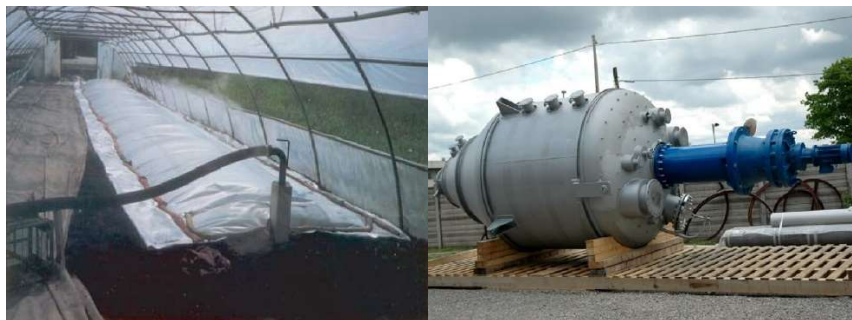
2. ábra Talajfertőtlenítés gőzzel és fóliával letakarva, illetve dobogőzölő felépítése [ https://www.megyerisabolcskerteszete.hu ]
