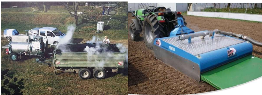
3. ábra Pótkocsin történő talajfertőtlenítés, illetve talajfertőtlenítés gőzölő ráccsal [ https://www.megyerisabolcskerteszete.hu ]
