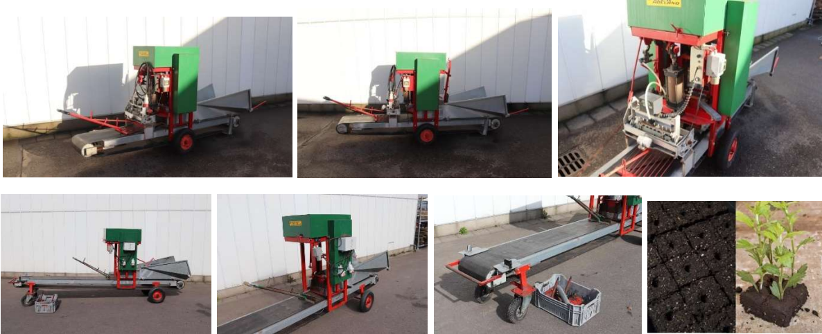
3. ábra Tápkockázógép és talajblokkoló szerkezeti felépítése [ https://www.duijndam-machines.com/hu ]
