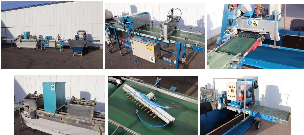
6. ábra Visser tálcát töltő és vető berendezés technológiai felépítése [ https://www.duijndam-machines.com/hu ]
