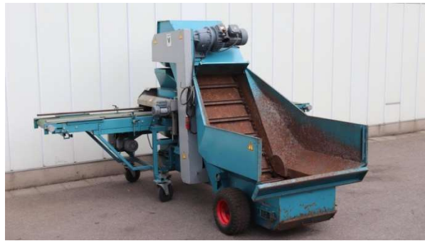
5. ábra Automatikus tápkockavető gép [LÁNG Z., 1999], [ https://www.duijndam-machines.com/hu ]
