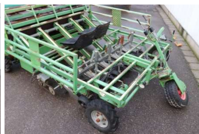
8. ábra Függesztett palántázógép 1 – palántázóelem, 2 – vázszerkezet, 3 – mélységhatároló, 4 – palántatartó [LÁNG Z., 1999], [SZENDRŐ P., 2003], [https://www.duijndam-machines.com/hu]
