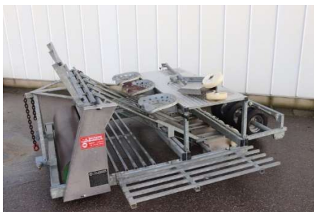
7. ábra Van den Beucken ültető gép palántázó technológiai felépítése [ https://www.duijndam-machines.com/hu ]
