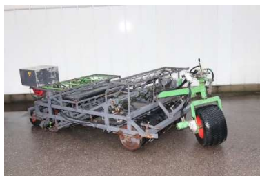
9. ábra Bütyköshengeres palántázógép 1 – tömörítőkerék, 2 – palántatartó asztal, 3 – nyitószerkezet, 4 – hárompontfelfüggesztés [LÁNG Z., 1999], [SZENDRŐ P., 2003], [https://www.duijndam-machines.com/hu]
