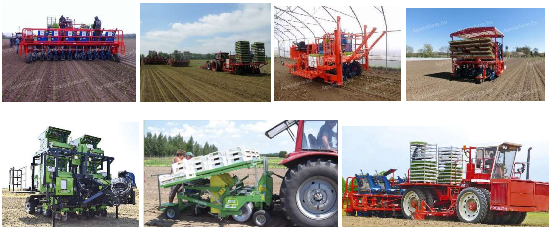
16. ábra Az Ferrari FUTURA Automata Ültetőgép [LÁNG Z., 1999], [SZENDRŐ P., 2003], [ https://www.agroinform.hu ], [ http://technika.gmgi.hu ]
