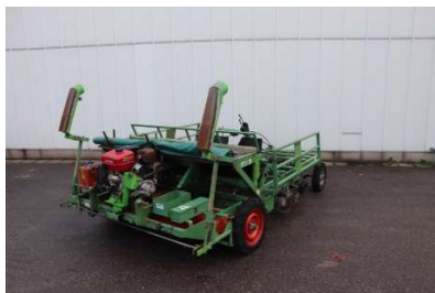
8. ábra Függesztett palántázógép 1 – palántázóelem, 2 – vázszerkezet, 3 – mélységhatároló, 4 – palántatartó [LÁNG Z., 1999], [SZENDRŐ P., 2003], [https://www.duijndam-machines.com/hu]
