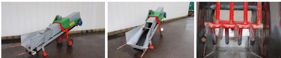
2. ábra Talajkeverő berendezés tápkockázáshoz [ https://www.duijndam-machines.com/hu ]
