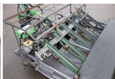
9. ábra Bütyköshengeres palántázógép 1 – tömörítőkerék, 2 – palántatartó asztal, 3 – nyitószerkezet, 4 – hárompontfelfüggesztés [LÁNG Z., 1999], [SZENDRŐ P., 2003], [https://www.duijndam-machines.com/hu]
