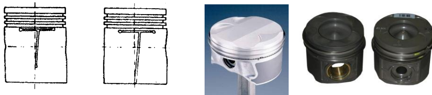
31. ábra Hasított dugattyú kialakítása
