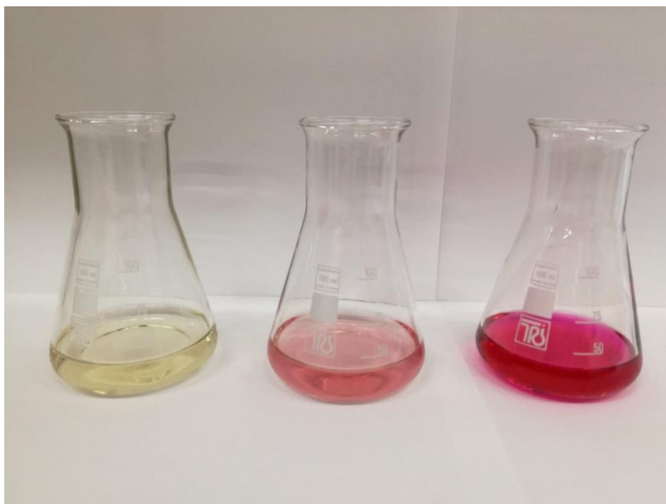
2. ábra Összes savtartalom meghatározás: a vizsgált minta (bal oldalon), a nátrium-hidroxid mérőoldattal megtitrált minta (középen) és nátrium-hidroxiddal túltitrált minta (jobb oldalon)
