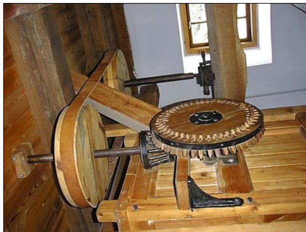
9.7. kép: Szélmalom hajtóműve – Ópusztaszeri Nemzeti Emlékpark
