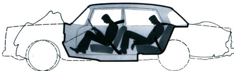
15.2. kép: A gyűrődő zóna viselkedése ütközés esetén
