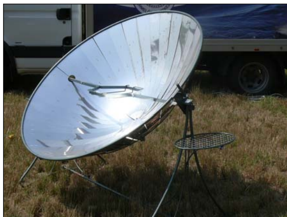
10.29. kép: Parabola tükrös napkonyha
