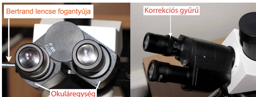
1.1. ábra A Brunel mikroszkópok okuláregységének felépítése
