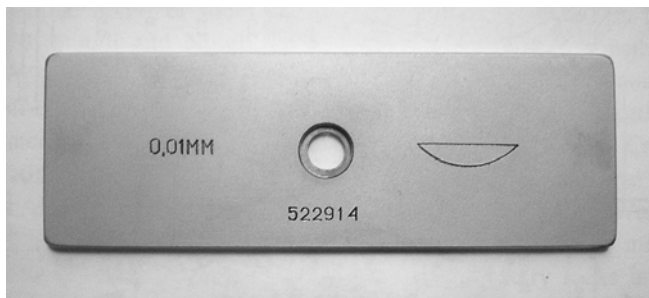
2.2. ábra A tárgyasztalra helyezhető mikrométer, a közepén a 10 \mu\text{m} -es osztásközü egységeket tartalmazó üveglemezzel.
