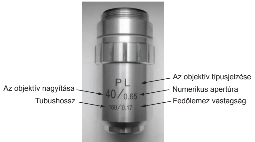
2.1. ábra A Brunel mikroszkópok objektíveinek jelölésrendszere.
