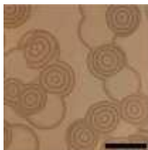
11.2. ábra. Mozgó csapadékmintázat képe a t = 390 s időpillanatban. A sáv 1 cm-t jelöl, [\text{Al}^{3+}] = 0,3 M, [\text{NaOH}] = 2,5 M [12].
