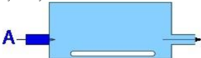
2.8. ábra. A folytonosan kevert tankreaktor sematikus rajza.
