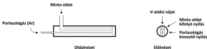
A V-vájatú porlasztó működése és felépítése
