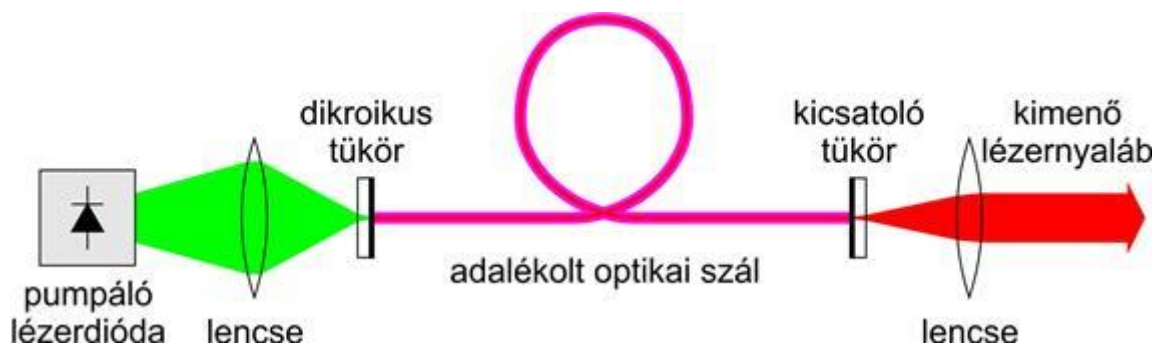
10.4. ábra. Egyszerű szál-lézer sematikus felépítése.
