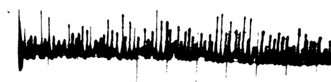
7.4. ábra. Egy korai fejlesztésű folytonosan pumpált szilárdtest lézer fényének tipikus időbeli viselkedése [7.4]. Az időskála 50 \mu s/osztás.
