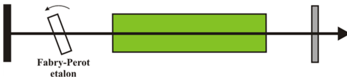
6.11. ábra. Fabry-Perot etalon elhelyezkedése a rezonátorban longitudinális módusszelekcióhoz.
