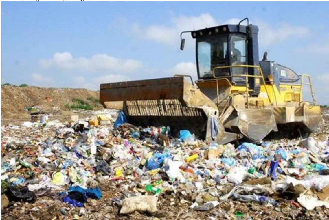
15. ábra A hulladék tömörítése kompaktortal (www.dafeszk.hu)
