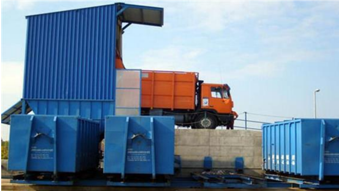
6. ábra Átrakó állomás, ahol a kiürített hulladékot egy présgép tömöríti, majd zárt konténerekbe kerül ( www.gyulaihirlap.hu )
