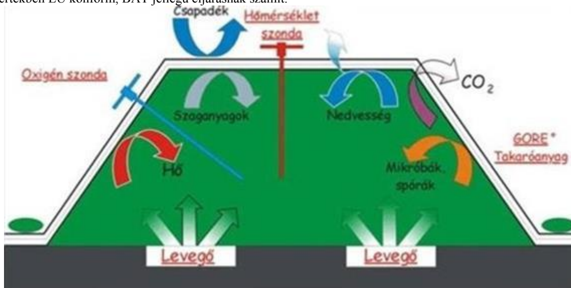
32. ábra Szemipermeábilis membrántakaróval takart prizmakomposztálás (Gore-Cover technológia) ( www.profikomp.hu/index2.php?tid=2 )
