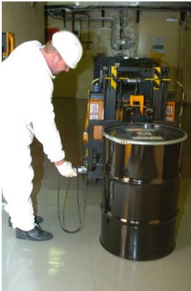
60. ábra Kis aktivitású hulladékot tartalmazó hordó dózisteljesítményének ellenőrzése ( atomeromu.hu/hulladekkezeles )
