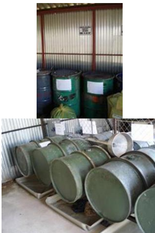
54. ábra Üzemi gyűjtőhelyen elhelyezett veszélyes hulladékok (a jobboldali képen a folyékony hulladékot tároló hordók alatt csepegést felfogó tálcát helyeztek el) (www.szrfk.hu)
