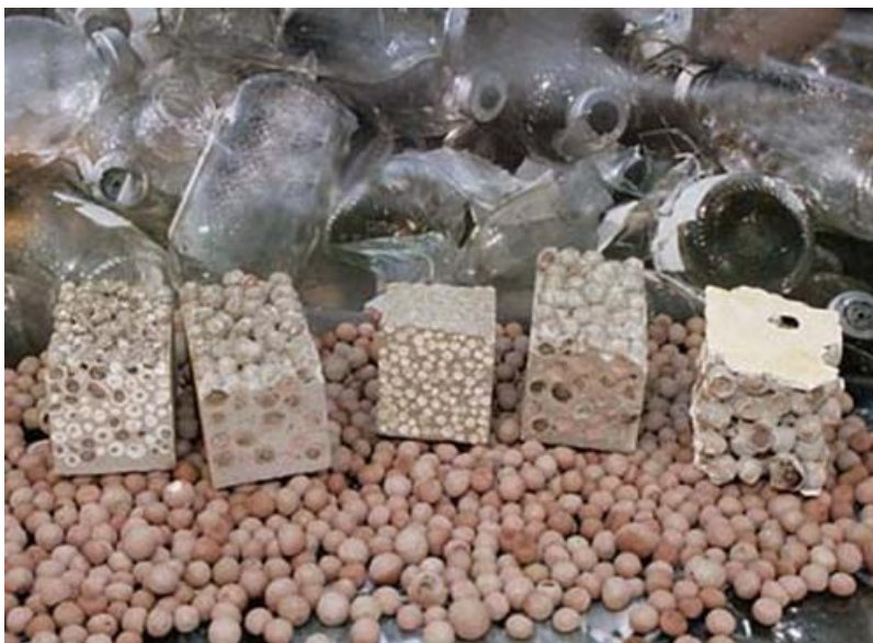
46. ábra Az üveghulladékból készült habkavics (www.geofil-bubbles.com)
