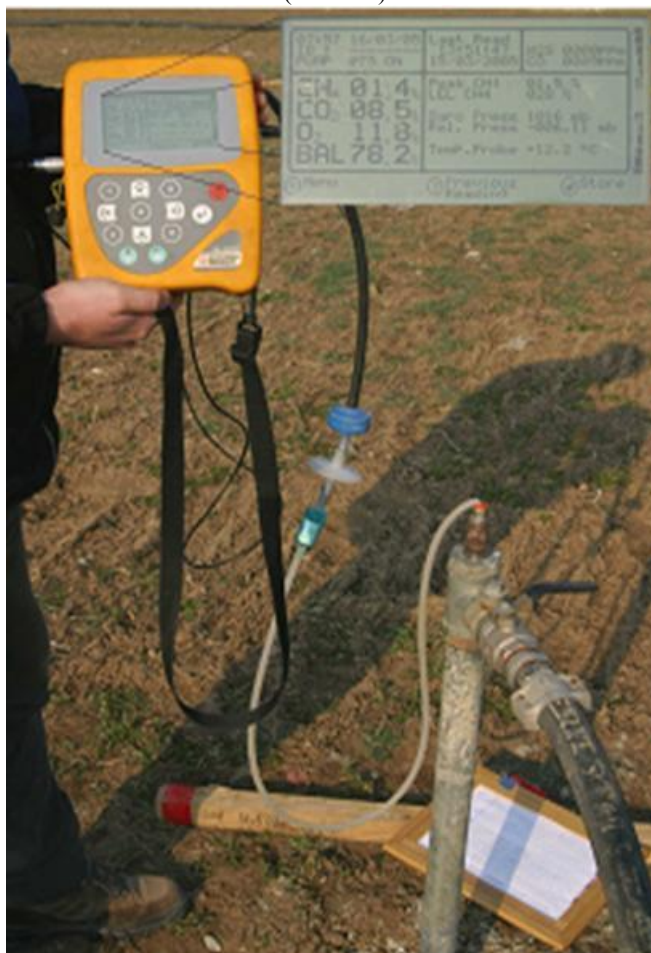
18. ábra Depóniagáz összetételének ellenőrzése (witch.pmmf.hu)
