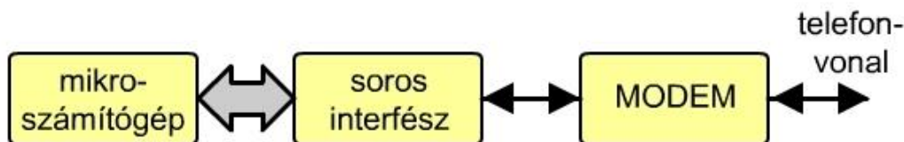
6.7. ábra. Adatátvitel mikroszámítógép és távbeszélővonal között.
