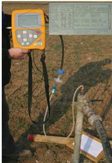
GA 2000 hordozható depóniagáz-elemző felépítése
