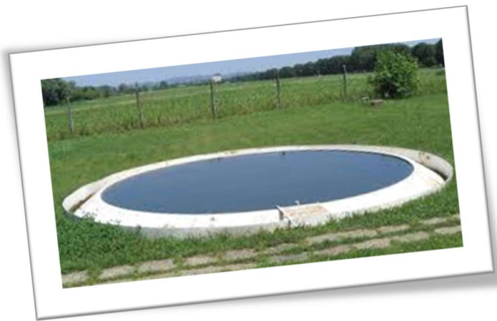
5. ábra. "U" típusú párolgásmérő kád.
