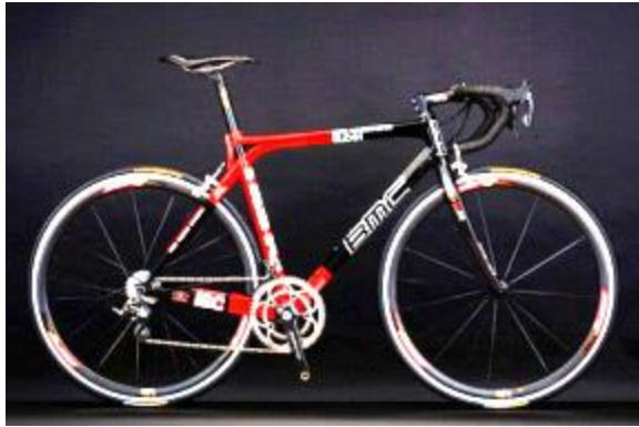
Szén nanocsővel erősített váz 2005, Tour de France, ARKEMA
