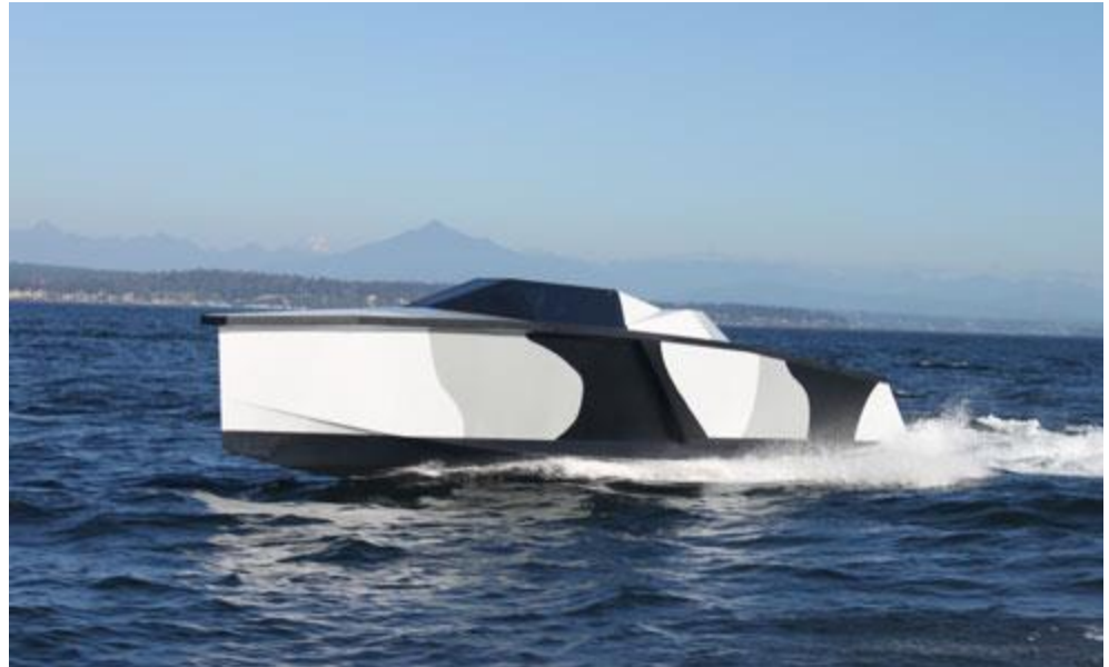
Piranha: 2010 ősz, Unmanned Surface Vehicle AROVEX™: Szén nanocső erősítés az epoxigyanta és a szénszál szövet között. Könnyebb, erősebb, több terhet tud vinni.
