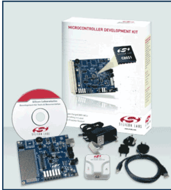
6.6. ábra: A C8051F120 fejlesztői csomag (Development Kit)
