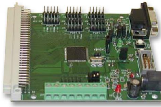
6.5. ábra: Mikrokontrolleres fejlesztő kártya
