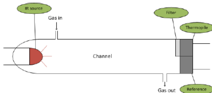
2.3. ábra: NDIR elven működő gázérzékelő elvi felépítése
