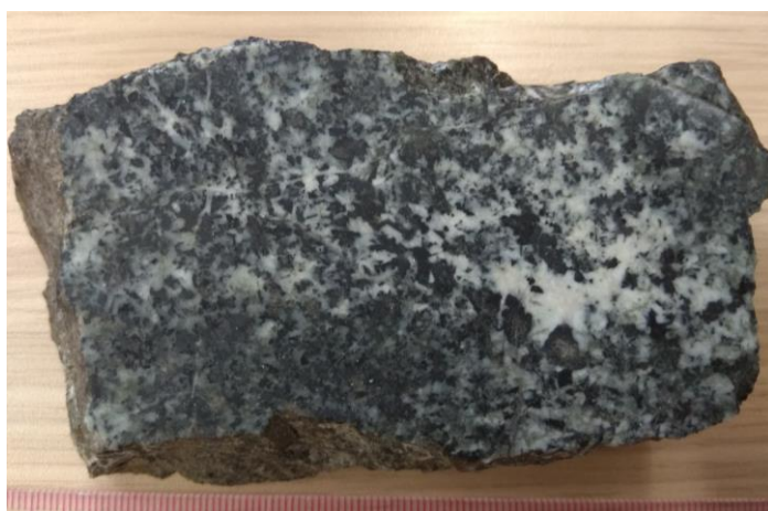
Szeperált, sajátalakú piroxénkristályok (balra), illetve kőzetalkotó hipidiomorf piroxénkristályok plagioklász földpátok mellett, gabbróban (jobbra; fekete szemcsék).
