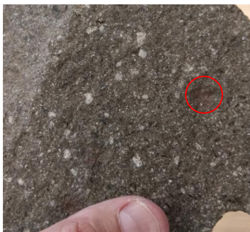
Bordó, izometrikus gránátkristály andezitben (balra; piros kör) fehér, táblás plagioklász és fekete, oszlopos amfibol szemcsék mellett, illetve eklogitban (jobbra).
