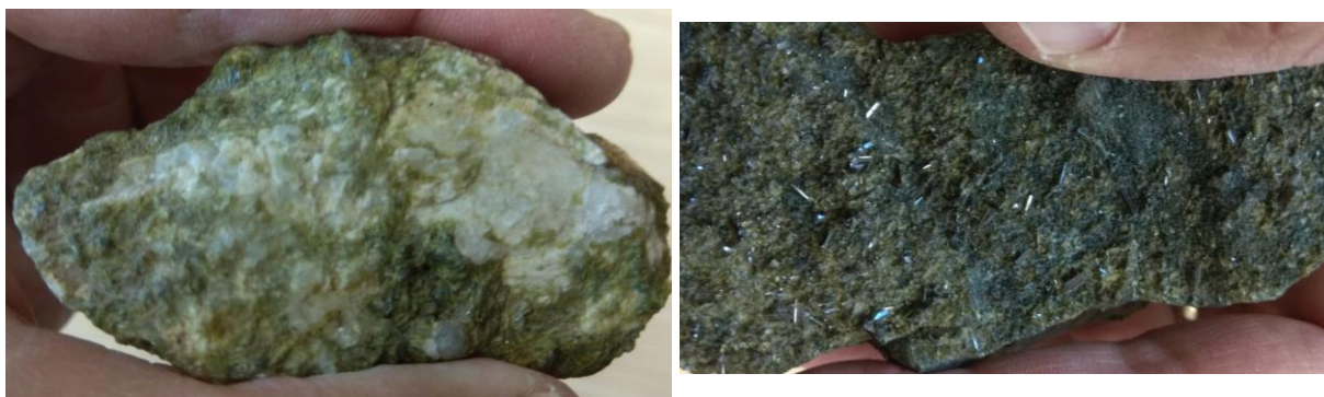
Pisztáciazöld, finomszemcsés epidot földpátkristályokkal (balra), illetve fennőtt, idiomorf, nyúlt oszlopos, zöldesfekete epidotkristályok megjelenése (jobbra).
