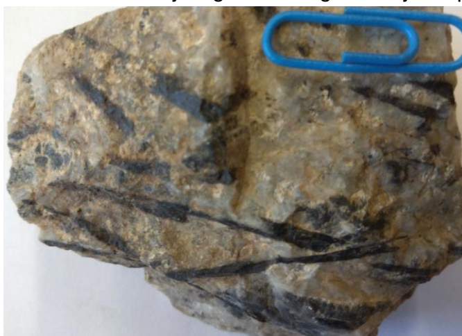
Nyúlt oszlopos, fekete turmalinkristályok kvarc és földpát mellett pegmatitban.
