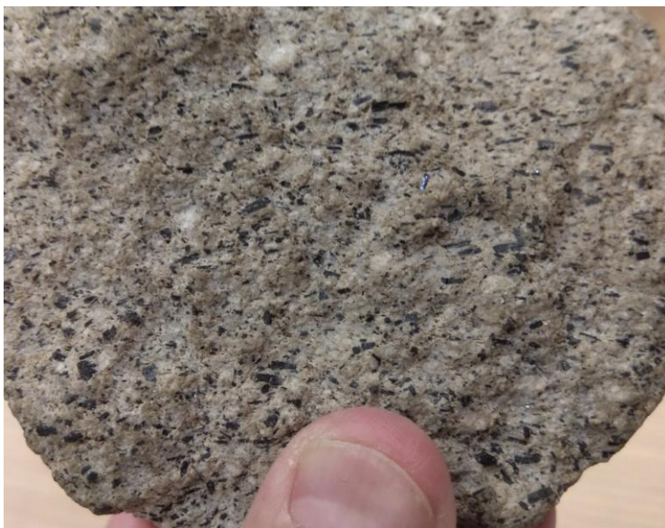
Nyúlt oszlopos tremolitból álló kevés halmaz (balra), illetve fekete, idiomorf, oszlopos hornblende fenokristályok andezitben (jobbra).
