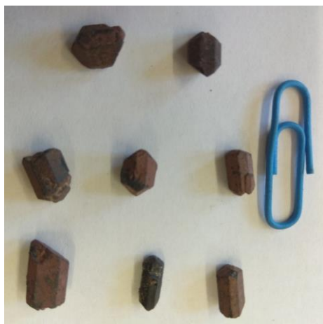
Szeperált, sajátalakú piroxénkristályok (balra), illetve kőzetalkotó hipidiomorf piroxénkristályok plagioklász földpátok mellett, gabbróban (jobbra; fekete szemcsék).
