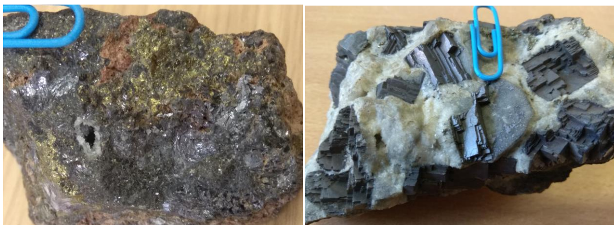
Szemcsés–pátos kifejlődésű galenitkristályok (világos ólomszürke) kalkopirittel, pirittel és kvarccal (balra), továbbá idiomorf, kocka szerinti hasadást mutató, sötétszürke galenit kalcittal (jobbra).
