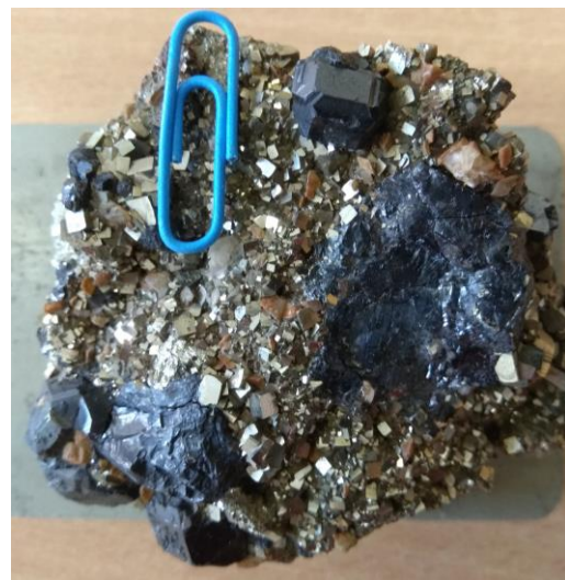
Vaskos–tömeges kifejlődésű szfaleritkristályok (fekete, kissé fémes fényű) kvarccal (balra), továbbá idiomorf, rostozott lapokkal jellemzett szfalerit (fekete) pirittel és galenittel (jobbra).
