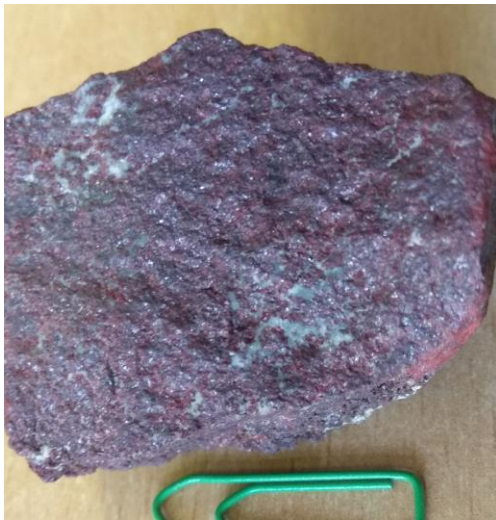
Idiomorf, cinnabaritkristályok halmazza (balra), továbbá vörös színű, hintett, üregkitöltő, finomszemcsés cinnabarit kvarccal (jobbra).
