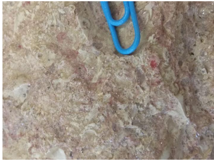
Idiomorf, cinnabaritkristályok halmazza (balra), továbbá vörös színű, hintett, üregkitöltő, finomszemcsés cinnabarit kvarccal (jobbra).
