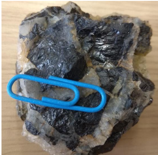
Vaskos–tömeges kifejlődésű szfaleritkristályok (fekete, kissé fémes fényű) kvarccal (balra), továbbá idiomorf, rostozott lapokkal jellemzett szfalerit (fekete) pirittel és galenittel (jobbra).
