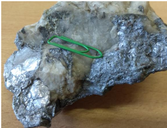
Idiomorf, lemezes molibdenit (fémes fényű, ólomszürke) kvarccal (balra), illetve szemcsés, bevonatszerű molibdenitkristályok (jobbra).
