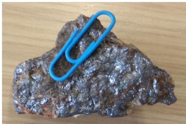
Idiomorf, lemezes molibdenit (fémes fényű, ólomszürke) kvarccal (balra), illetve szemcsés, bevonatszerű molibdenitkristályok (jobbra).
