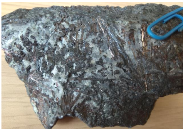
Áttetsző kalcitkristályon átnőtt idiomorf, tűs antimonit (fémes fényű, ólomszürke; balra), illetve kvarccal (jobbra).
