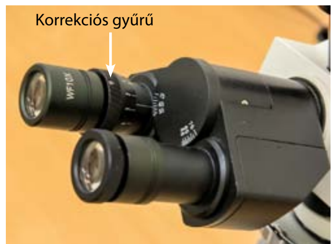
1.1. ábra A Brunel mikroszkópok okuláregységének felépítése
