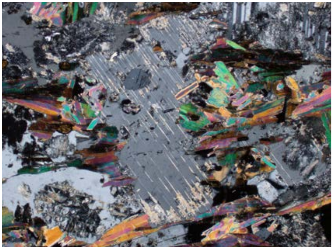
A hasadási nyomvonalak mentén kezdődő szericitesedést mutató plagioklász szemcse.
