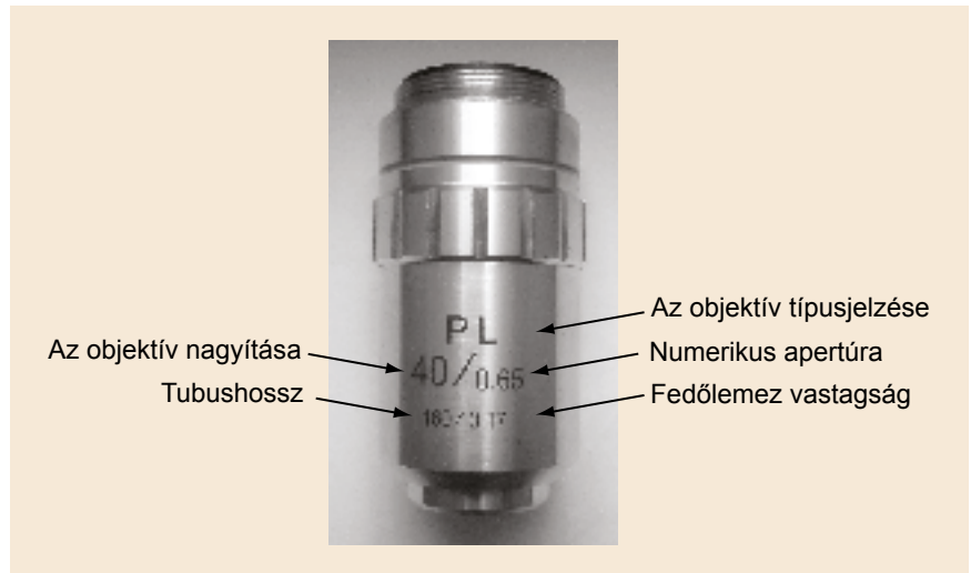
2.1. ábra A Brunel mikroszkópok objektíveinek jelölésrendszere.
