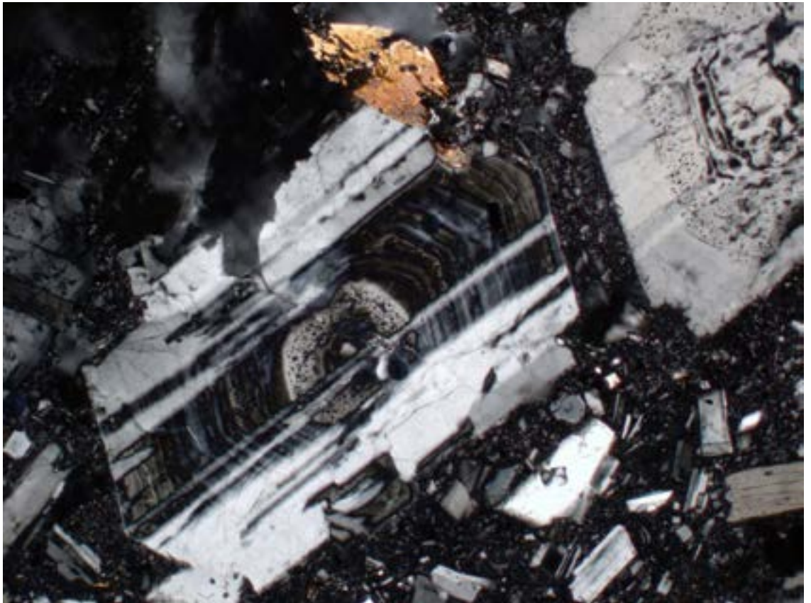
Oscillációs zónásságot és poliszintetikus ikerlemezességet mutató euhedrális plagioklász szemcse andezitben.
