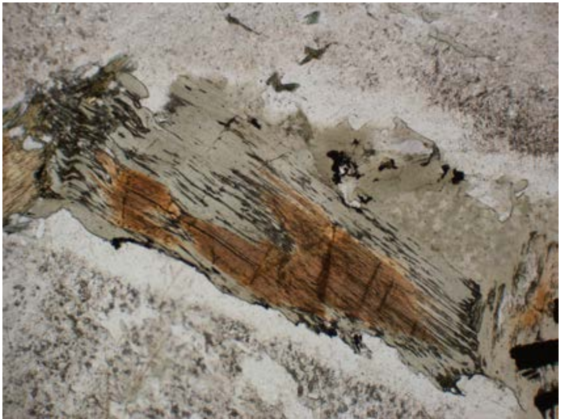
Erősen átalakult biotit szemcse kloritosodott szegéllyel gránitban.
