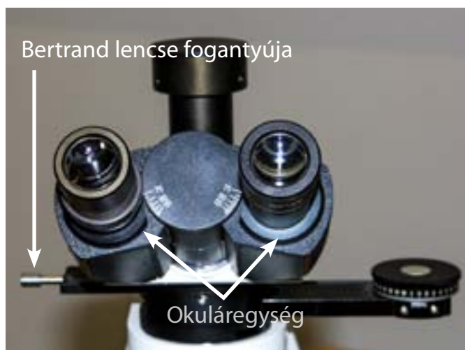
1.1. ábra A Brunel mikroszkópok okuláregységének felépítése
