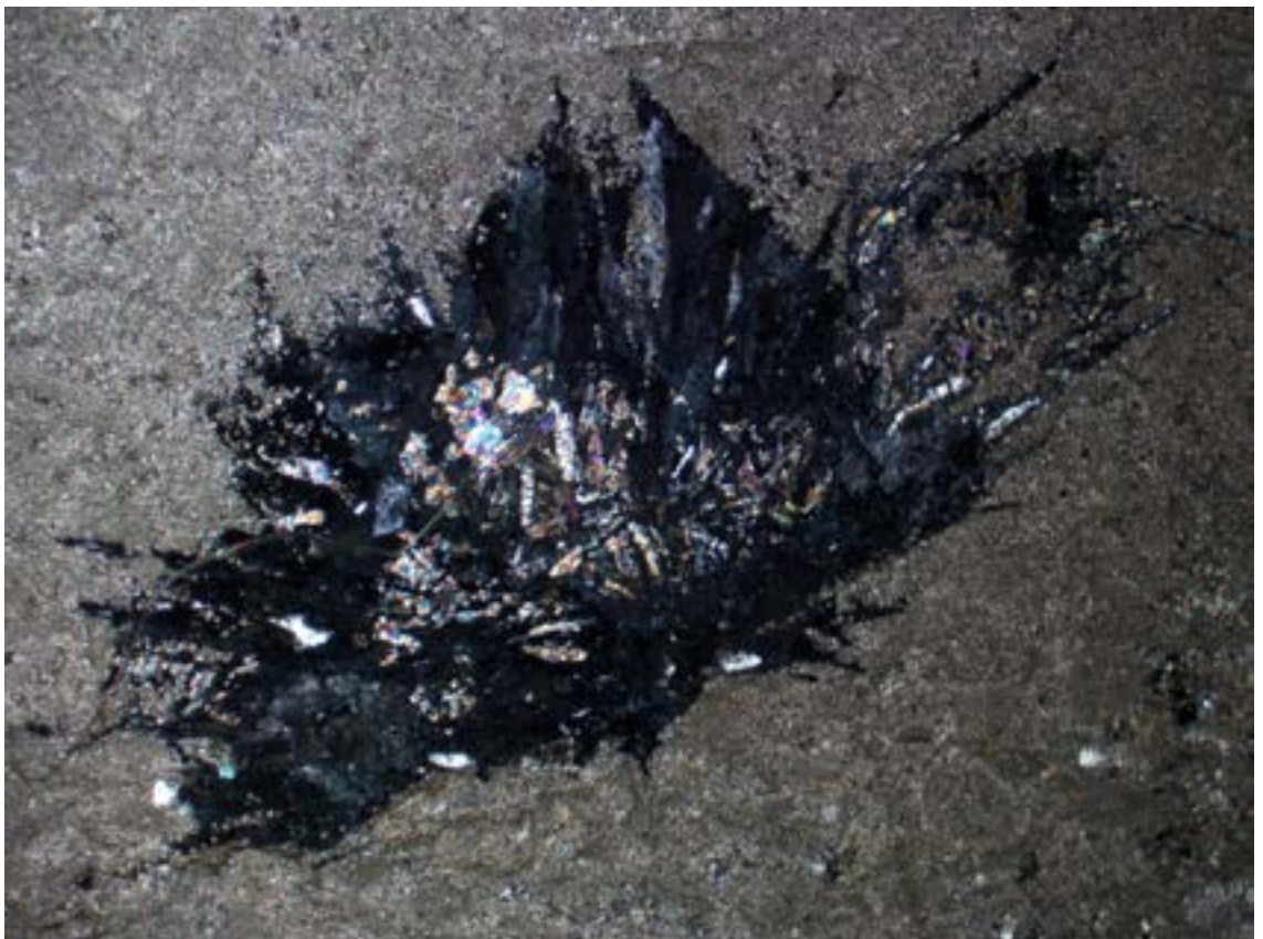
Szálas gipszgumó magas ineterferencia színű anhidrit zárványokkal.
