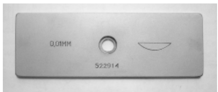
2.2. ábra A tárgyasztalra helyezhető mikrométer, a közepén a 10 µm-es osztásközű egységeket tartalmazó üveglemezzel.
