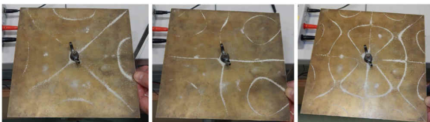
9. ábra. Chlandi-féle porábrák. Hegedűvonóval rezgésbe hozott vékony négyzet alakú fémllemezen kialakuló állóhullámok csomóvonalai szemléltetése.
