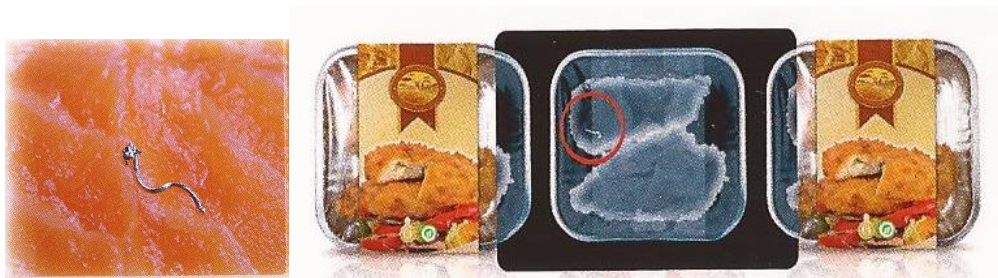
21. ábra: Hústerméken lévő fém szennyeződés (bal oldali kép) és a fémdetektor által mutatott felvétel (jobb oldali kép)
