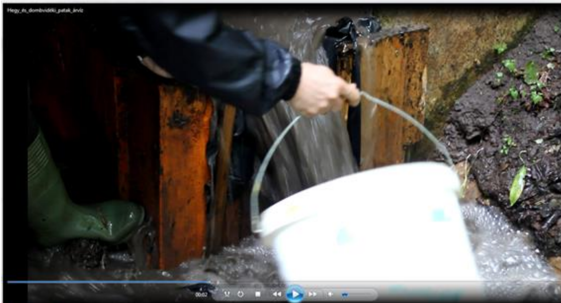
5.9. ábra - Rohanó, turbulens áramlás kialakulása műtárgy mögött, a Bükkösi-víz 2010 május 16.-i árvízi eseményekor (video)
