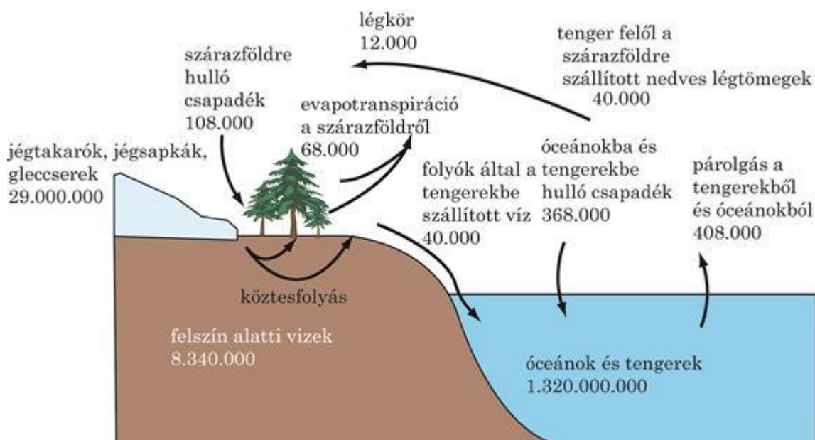
5.3. ábra - A hidrológiai ciklus kvantitatív ábrázolása. Az egyes tározókban \text{km}^3 , míg a nyilak mentén pedig \text{km}^3/\text{év} a mértékegység
