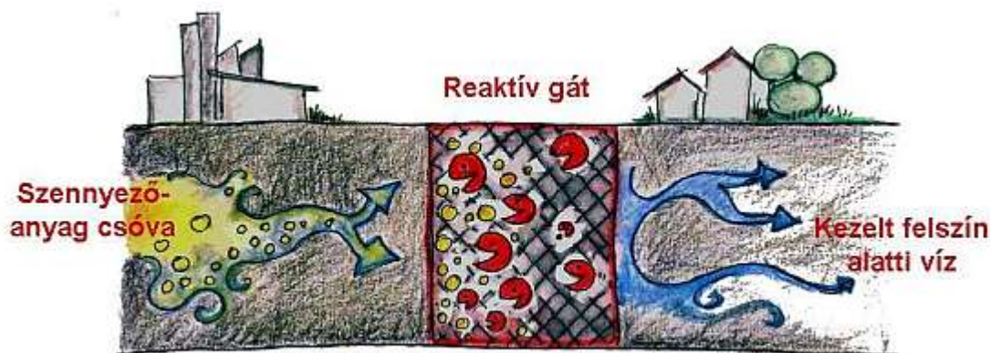
102. ábra - XIII.1. ábra A reaktív gát működésének sematikus ábrázolása
